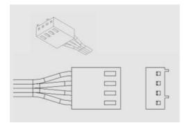
Pin#1- Ground (-) Pin#2- Power (+) Pin#3- Signal (Tachometer Output) Pin#4- PWM Control
